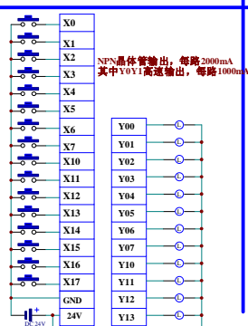
输入接线图 输出接线图
